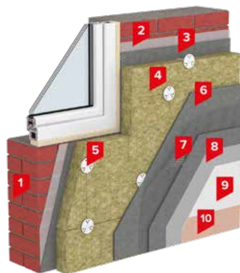
Рисунок 1. Система фасадная теплоизоляционная с тонким штукатурным слоем ТН-ФАСАД Декор
